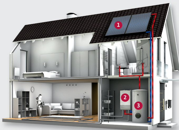
mit solarer Warmwasserbereitung
